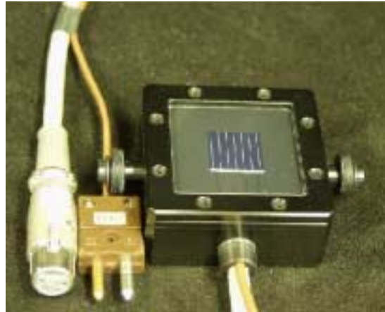
図2 推奨構造を満足する基準セルパッケージの例
